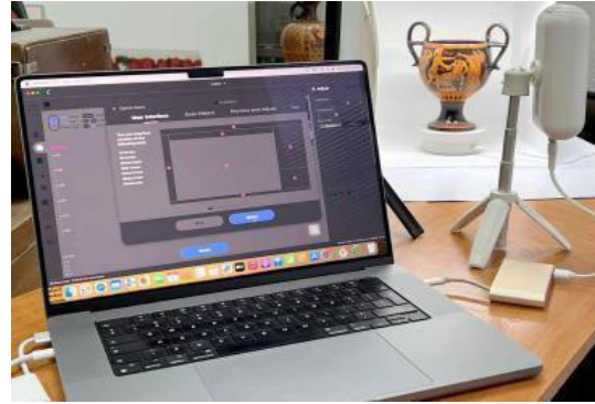
Слика 2: 3D скенирање со пренослив скенер, мал lightroom и ротирачка платформа. Извор на слика: Student Computer Art Societ
